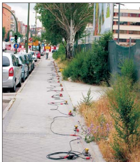
■ [Foto 2] Ejecución de medidas de Sísmica Pasiva en una calle de Madrid.
